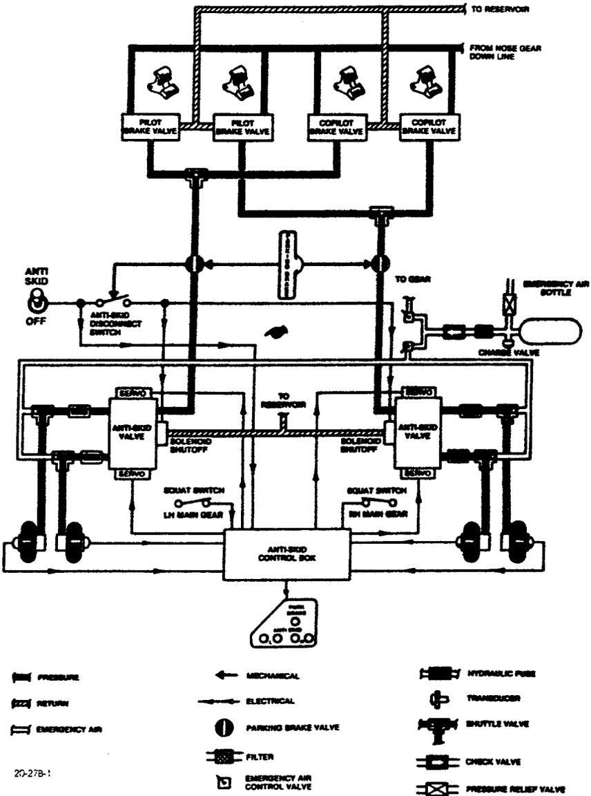
**WHEEL BRAKE SYSTEM SCHEMATIC**
